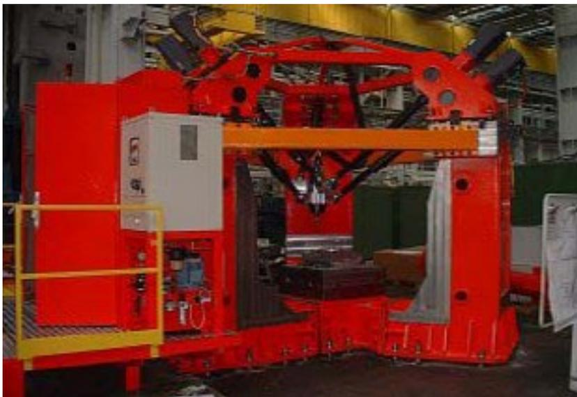
**Figura 10: PKM Celerius Concepita e sviluppata da ITIA-CNR nell'ambito del Programma Nazionale di Ricerca sui Sistemi di produzione Innovativi**
